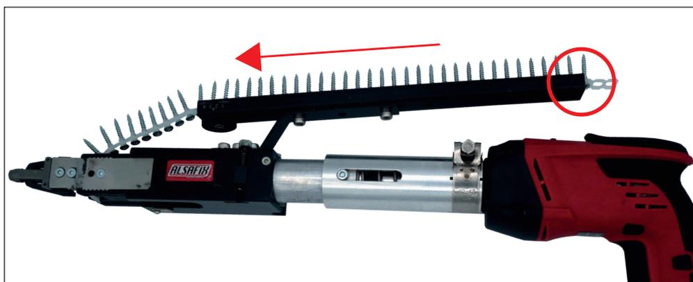
2. Faites glisser les vis en bande dans le guide, puis dans l'accessoire d'alimentation automatique.
