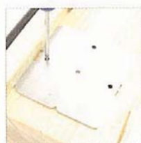
Marquer les perçages avec la platine de pointage
